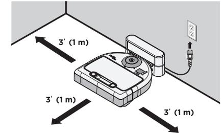
Stecken Sie das Netzkabel in die Steckdose und drücken Sie die Ladestation gegen die Wand. Drücken Sie die abgerundete Seite Ihres Neato gegen die Metallkontakte der Ladestation.
